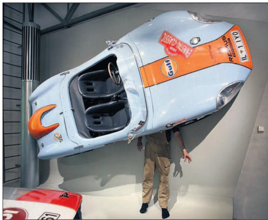
Der Colani GT aus dem Jahr 1964 ist ein Bausatz zur Selbstmontage auf VW-Käfer-Basis
